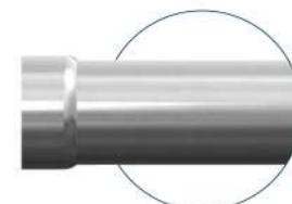
کاهش سرعت جریان هوا در این ساختار، موجب شکل گیری شعله ای نرم تر، پایدار تر و یکنواخت تر نسبت به کلاهک همگرا می شود. در این نوع کلاهک کاهش سرعت شعله ممکن است باعث افزایش جزئی در دمای شعله و در نتیجه تولید مقدار محدود  $\text{NO}_x$  شود، اما این میزان همچنان در محدوده ای قابل قبول باقی می ماند.
