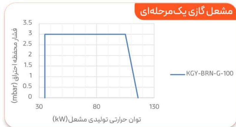
فشار ۵,۱۴ میلی‌بار بین ورودی و خروجی شیرگاز عملکردی ایمن و بهینه داشته باشند. برای جلوگیری از آسیب به تجهیزات متصل به مشعل در اثر افزایش فشار گازی ایمپاکت، استفاده از رگولاتور (کاهنده فشار) و گیج فشار به شدت توصیه می‌شود.
